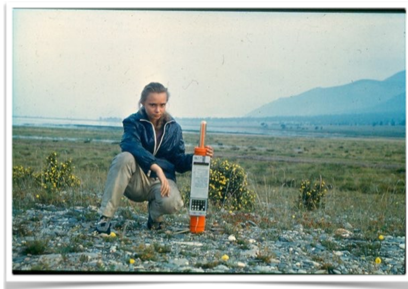
Испытания модифицированного радиобуя спутниковой связи «КОСПАС-САРСАТ»
