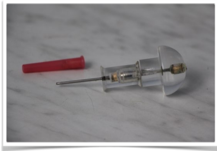
Опытный образец иглы-бура для внутрикостного доступа к кровеносной системе
