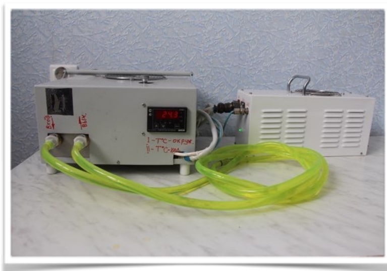
Экспериментальный вариант многофункционального устройства для терапевтической гипотермии, основанного на эффекте Пельтье
